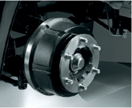
Freins à tambour avant et arrière Les freins extra-larges améliorent les performances de freinage.
