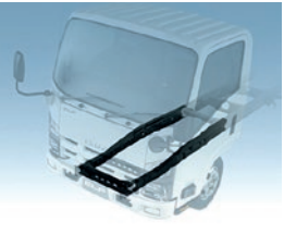
Renfort à l'intérieur du montant avant Non seulement le montant avant, mais également la zone allant du bas du pare-brise jusqu'au plancher ont été renforcés pour réduire la déformation de la cabine lors d'une collision frontale.
