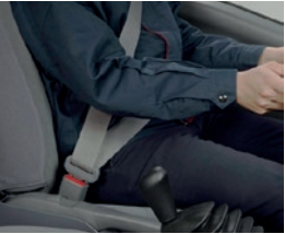
Ceintures de sécurité 3 points ELR* Retiennent et protègent efficacement le conducteur et les passagers en cas de collision. (*siège central: 2 points)
