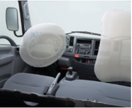
Airbags frontaux Deux airbags conducteur et passagers assurent une sécurité supplémentaire en cas de collision.
