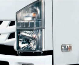
Phares halogènes. Les lentilles en résine transparente et les réflecteurs à gradins offrent un éclairage exceptionnel sur une large zone pour améliorer la visibilité et la sécurité nocturnes.
