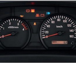
Les compteurs LED Des symboles d'avertissement conformes à la norme ISO. Plus faciles à lire, ils permettent au conducteur de vérifier l'état du véhicule d'un seul coup d'œil.
