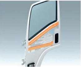
Taille de porte renforcée Minimise la déformation de la forme de la cabine en cas d'accident.
